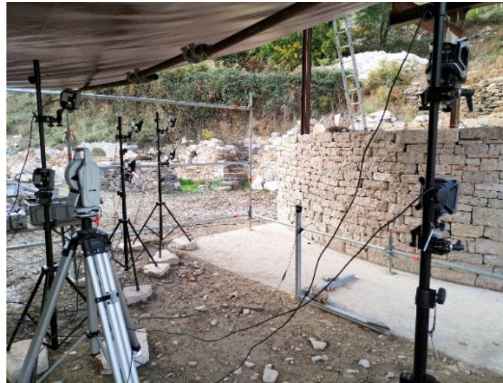
Installation du mur et des appareils de mesure sur la dalle d'essai de l'École professionnelle de la pierre sèche (2022).
