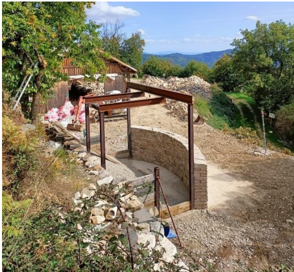
Installation du mur et des appareils de mesure sur la dalle d'essai de l'École professionnelle de la pierre sèche (2022).
