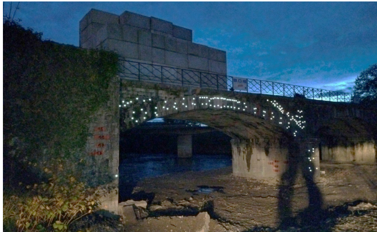
Cibles réfléchissantes lors de la calibration nocturne (2023).
